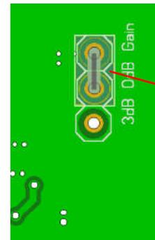
Jumper zur Einstellung der Verstärkung von 0 bzw. 3dB
