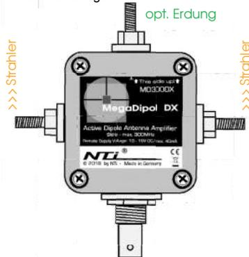
Wichtig ist, dass das Antennegehäuse mit nach unten gerichteter BNC-Buchse montiert wird, da sich auf der Unterseite zwei kleine Entlüftungslöcher zur Vermeidung von Kondenswasser befinden.
