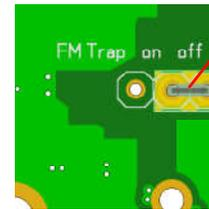
Jumper zum Zuschalten der UKW-Bandstop-Filters (FM Trap)
