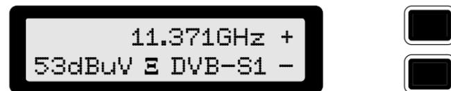
Die Antenne ist grob ausgerichtet; DVB-Aktivität ist bereits erkennbar (SL:1 Träger regeneriert), jedoch noch kein verwertbares Signal vorhanden.
