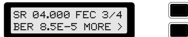
Über den Befehl "MORE" lässt sich ein weiteres Anzeigemenü speziell zur Feinjustierung der Antenne öffnen:
