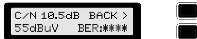
Hier werden übersichtlich zusammengefasst der digitale C/N-Wert, der Eingangspegel und die grobe Bitfehler-Rate(BER) in vier Stufen (unbrauchbar/schlecht/eingeschränkt/gut) angezeigt.
